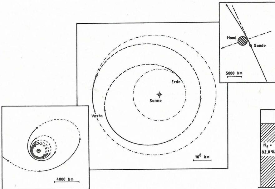
Raumsonde: Optimale (= treibstoffminimale) Flugbahn zum Planetoiden Vesta; Mond wirkt als Gravitationsschleuder; „Einschrauben“ der Sonde in eine Umlaufbahn um Vesta.
