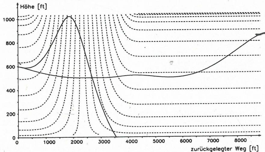
Boeing 727: Optimale (= sicherste) Flugbahn durch Fallwinde. Die „Absturzbahn“ ist miteingezeichnet.
