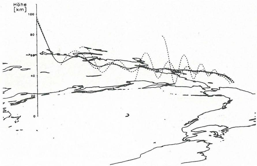
Raumgleiter: Optimale (= manövrierfähigste) Flugbahn über dem Pazifik. Nicht ausgezogene Kurvenstücke - - - : gestörte, aber bereits optimal ausgeregelte Flugbahnen.
